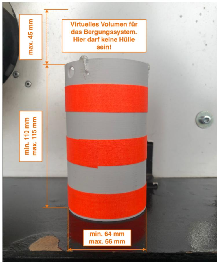
Abbildung 2 zeigt, dass das Einhalten der unter Punkt 2.1 und 2.2 der Designanforderungen vorgeschriebenen Abmessungen unbedingt erforderlich ist, damit die CanSats in die Rakete passen und sich beim Auswurf nicht verhaken.
